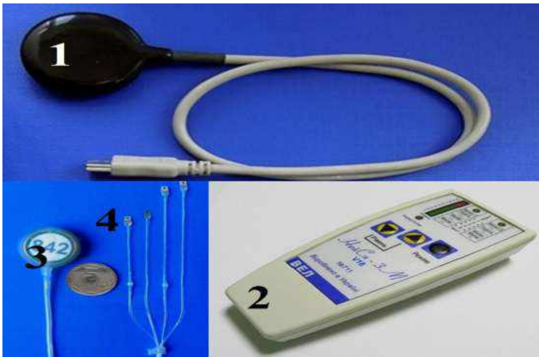
Рис. 4.5. Нейростимулятор «Нейсі 3М» (ВЕЛ, Київ, Україна). Зовнішня частина: 1 – антена-передавач, 2 – блок генератора імпульсів (суміщений із пультом управління); Імплантована частина: 3 – приймальна антена, 4 – електроди
