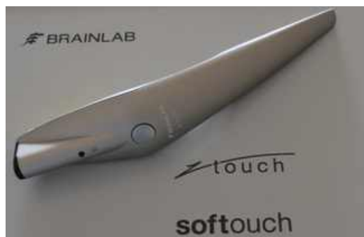
Рис. 6.4.2.2. Інфрачервона указка для реєстрації пацієнта.
