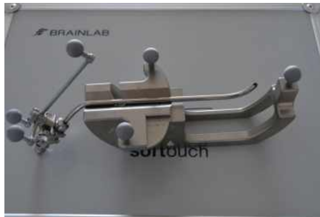
Рис. 6.4.2.6. Калібрувальний штатив для реєстрації інструментів під НН.
